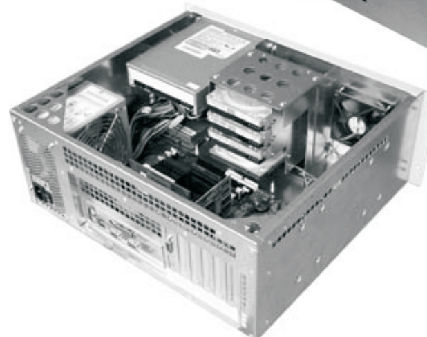
5. Корпус с установленными вентиляторами, материнской платой, FDD, CDROM. Вид справа.
