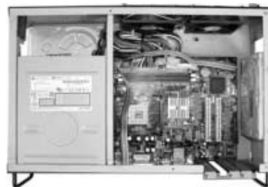
Фото 5. Корпус с установленными вентиляторами, материнской платой, HDD, CDROM. Вид сверху.
