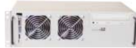
Фото 1. Крепление корпуса к рэкам с лицевой стороны
