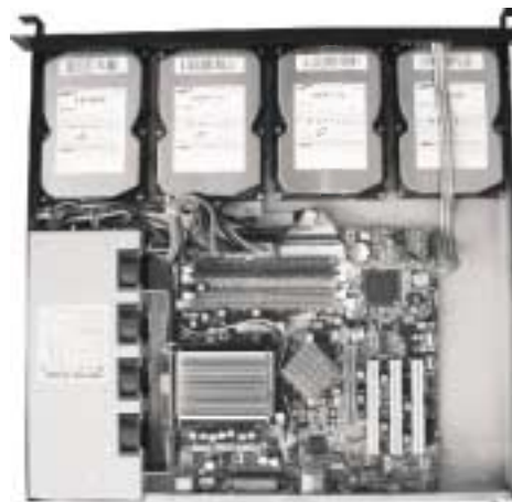
Фото 3. Корпус D14200 с установленными материнской платой, HDD. Вид сверху
