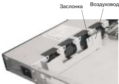
Фото 1. Размещение воздуховода с заслонкой в корпусе.
