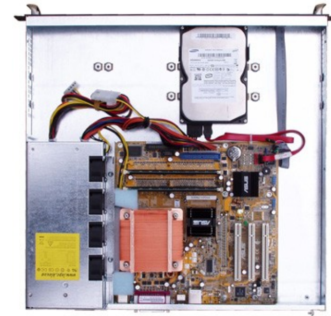
Фото 4. Комп'ютер, зібраний в корпусі D14
