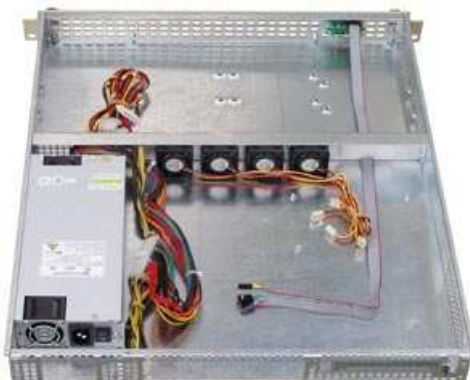
Фото 2. Корпус D17 з чотирма вентиляторами
