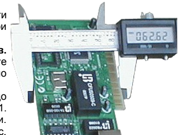
Фото 5. Вимірювання висоти плати розширення
