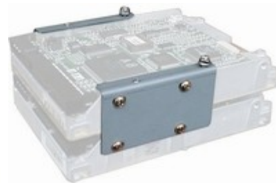
Фото 3. Корзина для двох HDD (лівий і правий фланці)
