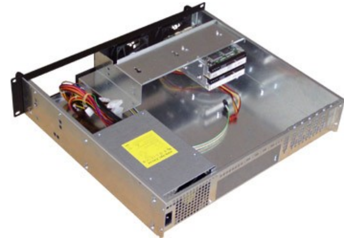
Фото 4. Корпус з установленою корзиною HDD
