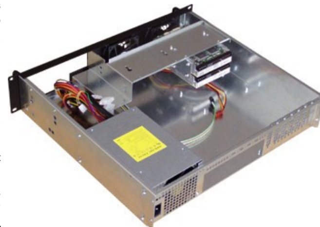
Фото 4. Корпус з установленою корзиною HDD
