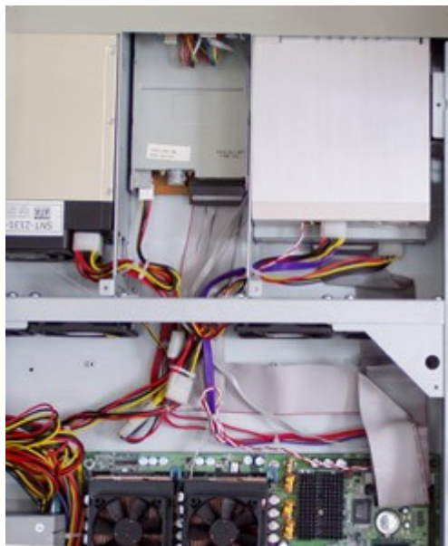
Фото 2. Прокладання шлейфів в корпусі
