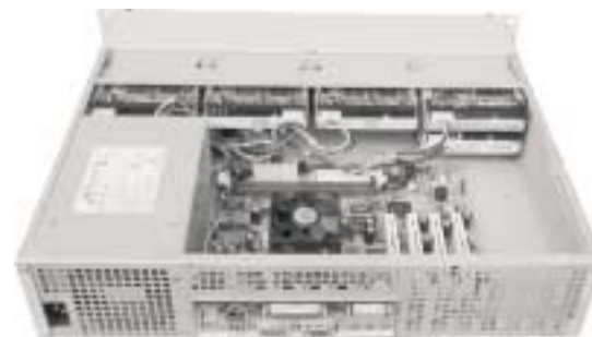
Фото 4. Корпус с установленными вентиляторами, материнской платой, HDD.
