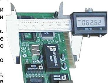
Фото 3. Вимірювання висоти плати розширення
