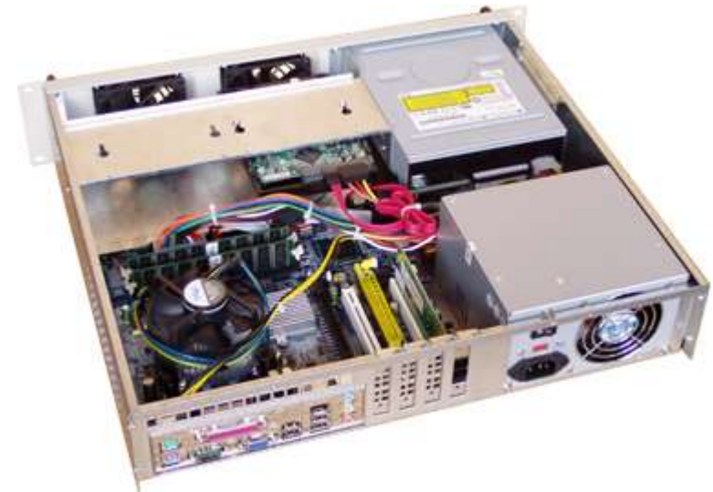
Фото 3. Корпус з установленими компонентами
