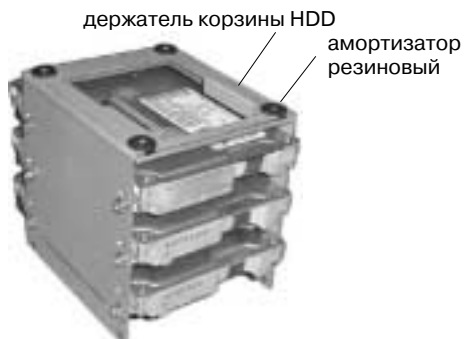
Фото 1. Корзина HDD с держателем и амортизаторами.
