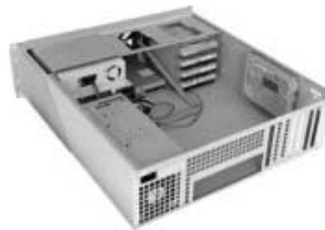
Фото 4. Крепление корзины HDD в корпусе D33-H1.
