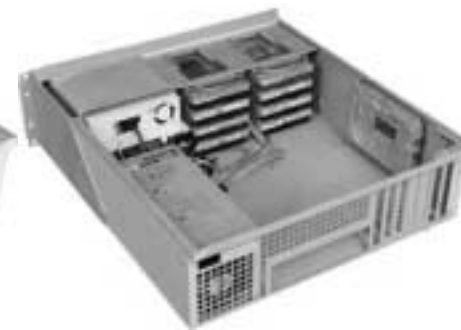
Фото 5. Крепление двух корзин HDD в корпусе D33-H2.
