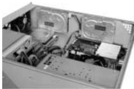
Фото 2. Крепление HDD в базовой версии корпуса возле FDD перед вентилятором и на боковой панели.
