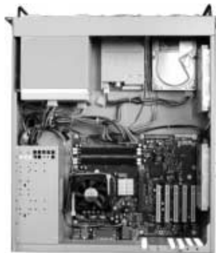
Фото 3. Корпус с установленными вентиляторами, 5,25" устройствами, HDD, материнской платой.
