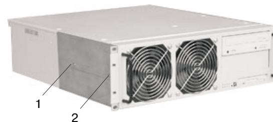
Фото 3. Крепление держателей при транспортировке корпуса.
