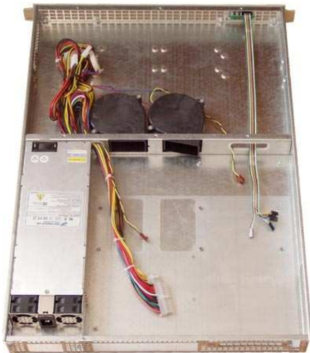
Фото 1. Корпус з установленими передньою панеллю, блоком живлення, вентиляторами
