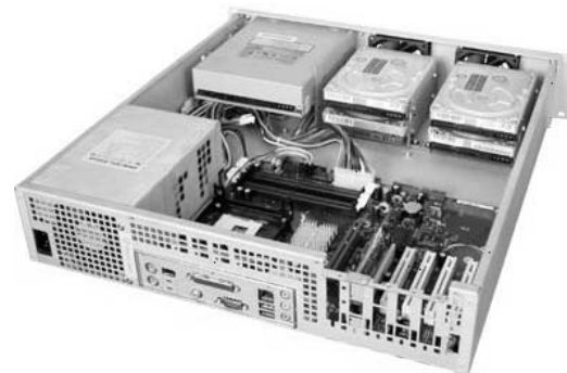
Фото 5. Корпус с установленными вентиляторами, материнской платой, HDD, FDD, CDROM. Вид сзади.
