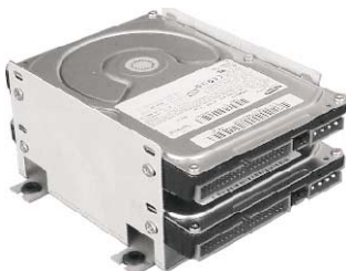
Фото 4. Корзина с двумя HDD. Внизу видны резиновые амортизаторы.
