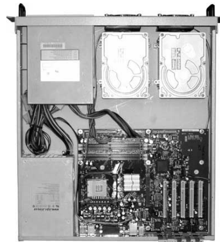
Фото 6. Корпус с установленными вентиляторами, материнской платой, HDD, FDD, CDROM. Вид сверху.
