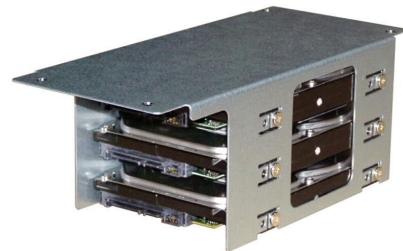
Фото 1. Тримач - корзина з трьома HDD
