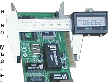
Фото 3. Вимірювання висоти плати розширення
