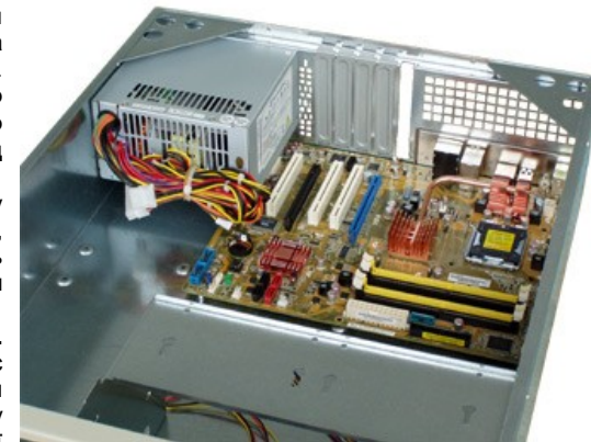
Фото 3. Материнська плата ATX в корпусі DL32, блок живлення нависає над краєм плати.
