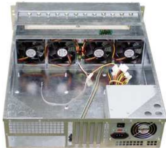
Фото 1. DL36 з установленими вентиляторами і платою FanMagic
