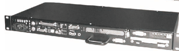
Фото2. Крепление корпуса к рэкам с тыльной стороны
