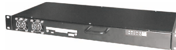
Фото1. Крепление корпуса к рэкам с лицевой стороны
