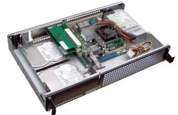
Фото 2. Корпус з материнкою Mini-ITX, двома HDD та двома платами розширення на райзері 1U5Rx2
