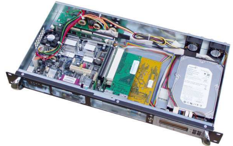
Фото 2. Корпус з материнкою, двома картами розширення на райзері 1URx2, HDD та контроллером TeleServ (опційна комплектація)
