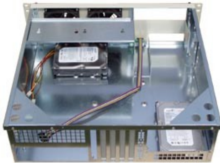
Фото 1. Два HDD кріпляться на днищі.
