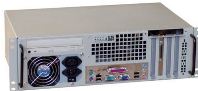
Фото 5. Комп'ютер зібраний для кріплення в 19" стійці коннекторами в/в наперед.
