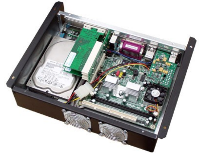
Фото 3. Корпус з установленими материнською платою, блоком живлення, HDD, двома картами розширення на райзері.
