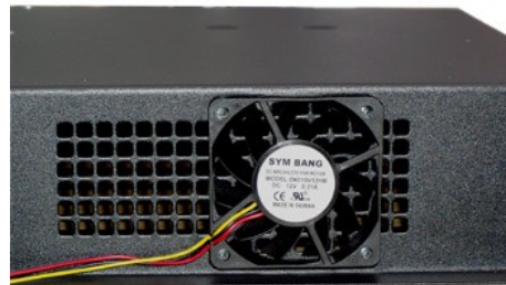
Фото 2. Установка додаткового вентилятора на боковій панелі ззовні корпусу.
